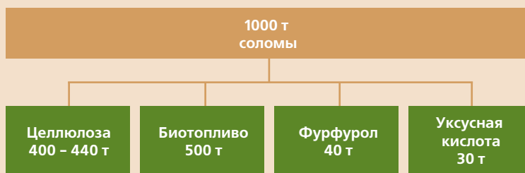
Рис. 3. Получение целлюлозы и продуктов с добавленной стоимостью из соломы по методу Chempolis
